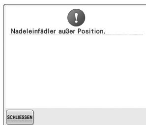
**Beim Einfädeln des Fadens in die Nadel mit dem automatischen Nadeleinfädlermechanismus wurde ein anderer Vorgang durchgeführt.**
