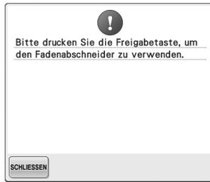
**Die Fadenabschneidetaste wurde vor der Freigabe der Maschine gedrückt.**
