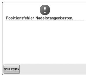
**Der Nadelstangenkasten hat an einer falschen Position angehalten.**
