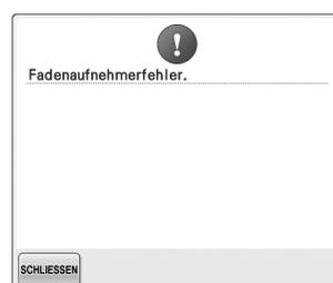
**Der Fadenaufnehmer funktioniert nicht richtig.** Entfernen Sie den im Fadenaufnehmer verfangenen Faden.
