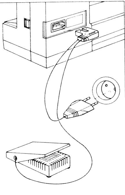
**Elektrischer Anschluß:** Anlasser auf den Boden stellen. Stecker N in die Maschine, und Stecker O in die Wandsteckdose stecken.
