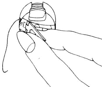
**Spulenkapsel einsetzen:** ● *Hauptschalter 8 ausschalten.* Klappe Q anheben und die Kapsel bis zum Anschlag auf Stift R schieben. Ausschnitt S muß dabei nach oben zeigen.
