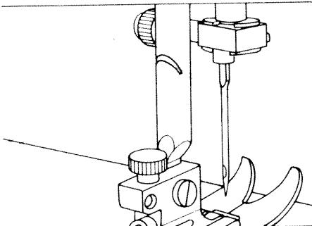
**Fadenabschneider P:** Fäden einlegen und nach unten ziehen.
