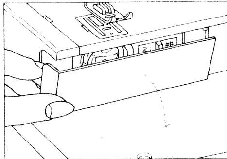
Verschlußklappe 19 nach unten öffnen.
