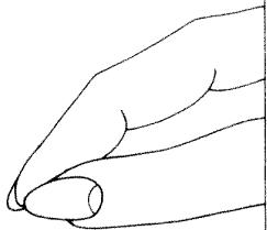
**Unterfadenspannung prüfen:** Kapsel leicht ruckartig aufwärtsbewegen. Sie muß stufenweise niedersinken. (Einstellschraube P nach links drehen = loser, nach rechts drehen = fester).
