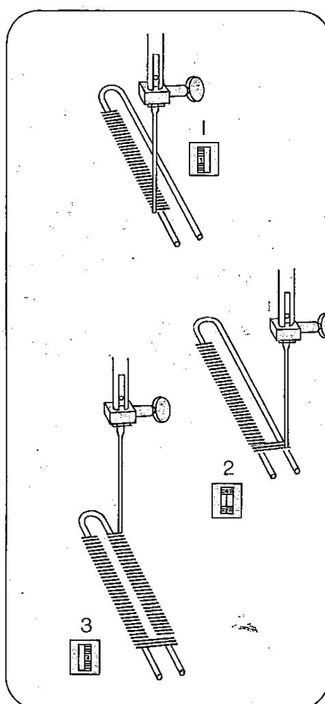
3 Hebel 6 über Raupensymbol I schieben. Zweite Raupe in der gleichen Länge wie die erste nähen. Nadel hochstellen.
