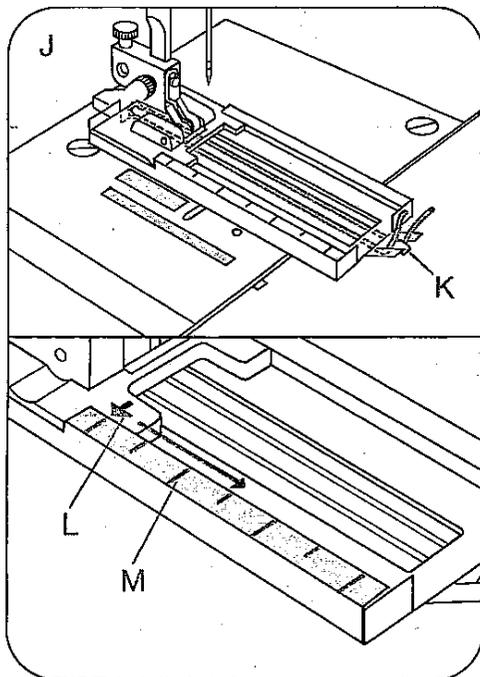
Beim Nähen läuft der Pfeil L an der Skala M entlang. Dadurch kann die Knopflochlänge bestimmt werden.
