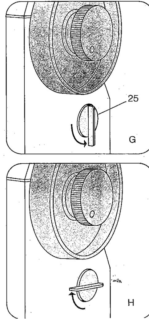
Spulenkapsel und Spule herausnehmen
