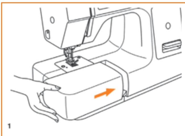
Sie wird durch Anheben der Abdeckung am gezeigten Pfeil geöffnet. (2)
