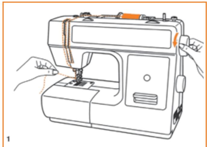
Am Oberfaden ziehen und den Unterfaden durch das Loch in der Stichplatte heraufbringen.
