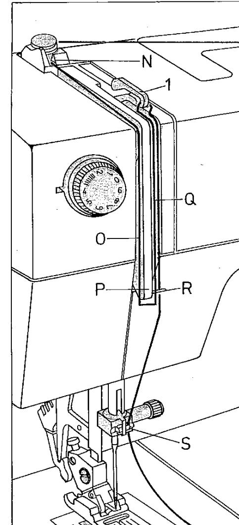
**Oberfaden einlegen:** ● **Hauptschalter 8 ausschalten.** Nadel und Fadenhebel 1 müssen oben stehen. Nähfuß anheben. Den Faden von der Garnrolle in die Spulervorspannung, durch die Öffnung N, den Schlitz O, hinter das Führungsstück P, nach oben in den Schlitz Q, durch den Fadenhebel 1, zurück durch den Schlitz Q, hinter die Führung R und in die rechte Fadenführung S am Nadelhalter ziehen.
