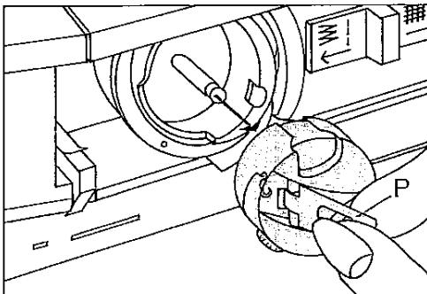
**● Hauptschalter 8 ausschalten. Klappe P anheben und die Spulenkapself herausziehen.**
