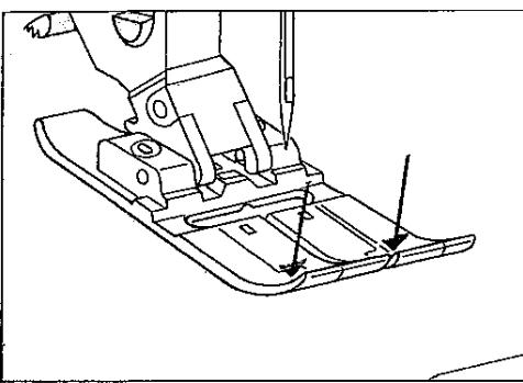
**Nähfuß auswechseln:** Hauptschalter 8 ausschalten. Die Nadel hochstellen. Den Nähfuß vorne nach unten drücken, der Fuß rastet dabei aus. Beim Knopflochfuß muß zuerst die Schiene nach vorne gezogen und die Nähfläche herausgenommen werden.
