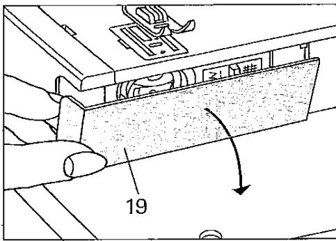
**Verschlußklappe 19 nach unten öffnen.**
