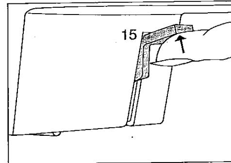
**Beim Einlegen extrem dicker Stofflagen Hebel 15 höher anheben.**
