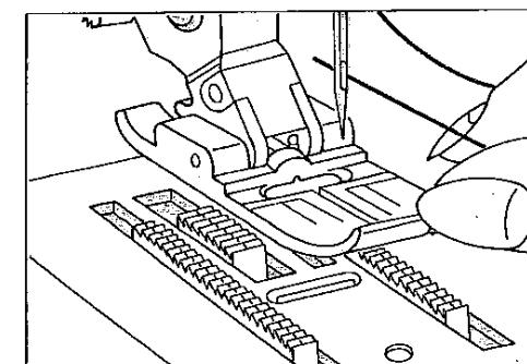
**Den Oberfaden von vorn nach hinten durch das Nadelöhr fädeln.**
