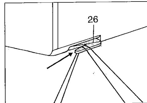
Fadenabschneider 26. Fäden einlegen und nach unten ziehen.
