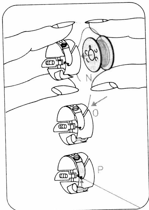
**Spule einlegen N** (Faden nach hinten). Den Faden in den Schlitz O und bis zur Öffnung P ziehen.
