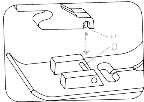
**Nähfuß anbringen:** Stoffdruckerhebel senken und den Fuß dabei so schieben, daß der Steg O in die Nuten P einrastet.
