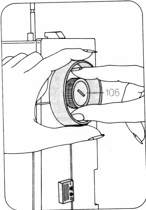
**Nähwerk einschalten:** Handrad festhalten und Scheibe 106 nach hinten drehen. Dann Handrad nach vorne drehen, bis es einrastet.
