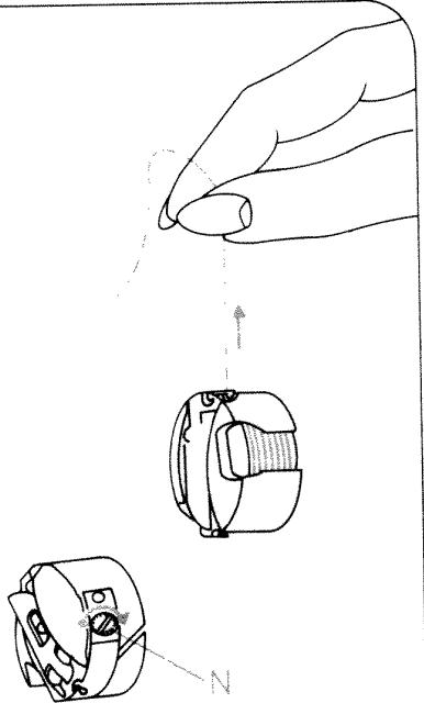
**Unterfadenspannung prüfen:** Kapsel leicht ruckartig aufwärtsbewegen. Sie muß stufenweise niedersinken. (Einstellschraube N nach links drehen = loser, nach rechts drehen = fester).
