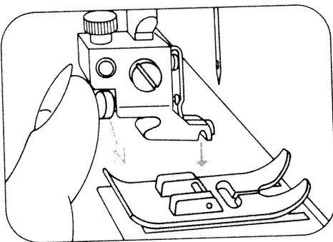
**Nähfuß auswechseln:** ● Hauptschalter 125 ausschalten. Roten Knopf N drücken. Der Fuß rastet aus.
