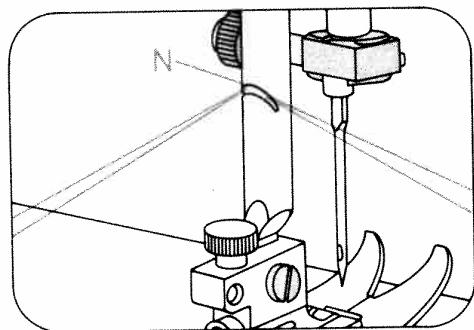
**Fadenabschneider N.** Fäden einlegen und nach unten ziehen.
