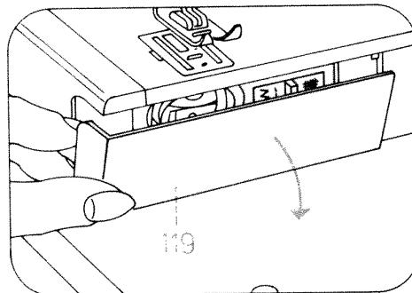
Verschlußklappe 119 nach unten öffnen.
