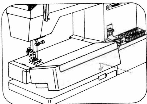
Nähfläche, wie der Pfeil zeigt, an die Maschine schieben.
