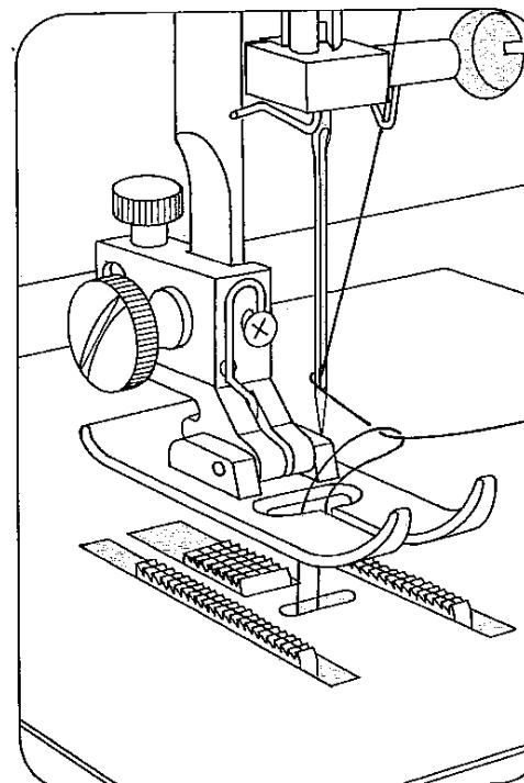
Oberfaden festhalten. Handrad nach vorn drehen und einen Stich nähen. Nadel und Fadenhebel müssen oben stehen. Mit dem Oberfaden den Unterfaden nach oben ziehen.
