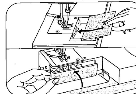
Grundplattendeckel 25 einsetzen, oder Verschlußklappe 10 schließen.
