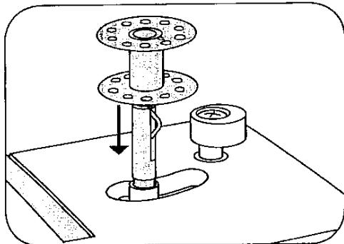
Spule auf die Spulerspindel 5 stecken.
