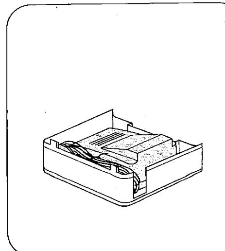
In der umgedrehten Anschiebe-Nähfläche ist der Anlasser untergebracht.
