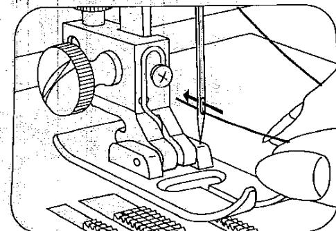
Den Oberfaden von vorn nach hinten durch das Nadelöhr fädeln.
