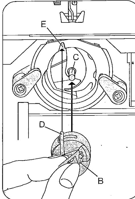
**Spulenkapsel einsetzen:** Klappe B anheben und die Kapsel bis zum Anschlag auf Stift C schieben. Der Kapselfinger D muß dabei in den Ausschnitt E eingreifen.
