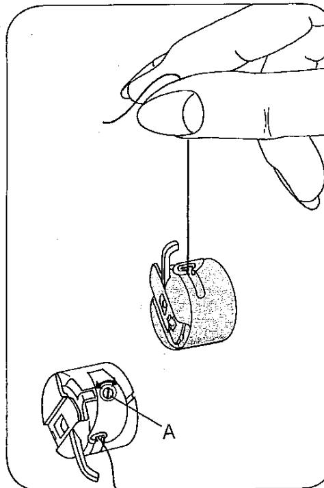
**Unterfadenspannung prüfen:** Kapsel leicht ruckartig aufwärtsbewegen. Sie muß stufenweise niedersinken. (Einstellschraube A nach links drehen = schwächer, nach rechts drehen = fester).
