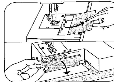
**Grundplattendeckel 25 abnehmen, oder Verschlußklappe 10 nach unten öffnen.**
