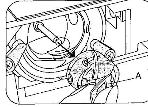
**Klappe A anheben und die Spulen-kapsel herausziehen.**
