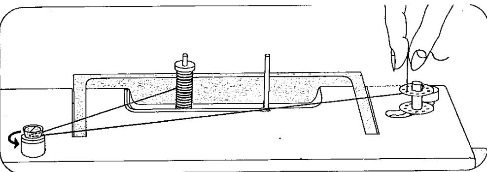
**Spulen:** Den Faden von der Garnrolle in die Spulervorspannung 2 ziehen, zur Spule führen, durch ein Loch der Spule fädeln und festhalten. Den Fußanlasser betätigen und aufspulen. Dabei den Faden nach einigen Umdrehungen loslassen. Die volle Spule nach links drücken, abnehmen und den Faden abschneiden.
