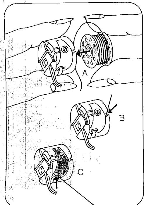
**Spule einlegen A (Faden nach hinten).** Den Faden in den Schlitz B und unter der Feder hindurch in die Öffnung C ziehen.
