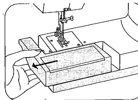
**Spulen vorbereiten:** Unter die Nähfläche 9 greifen und diese nach links herausziehen.
