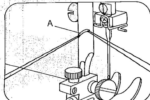
Fadenabschneider A. Fäden einlegen und nach unten ziehen.
